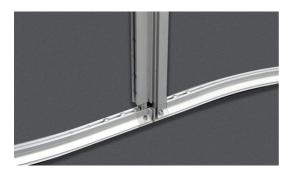
5. Schieben Sie unten, in die Mitte und Oben eine Verbindungs- schraube durch die dafür vorgesehenen Löcher und verbinden Sie diese fest miteinander.
