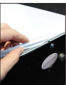
Führen Sie das Kederprofil in die vorgesehene Nut des Profils ein. Achten darauf, dass Hände entsprechend sauber sind um eine Verschmutzung vorzubeugen. Wiederholen Sie diesen Schritt an allen 4 Seiten
